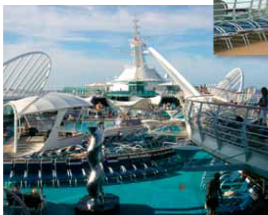
orkesterikorokkeen putkikäyrät Ø168,3 R-2000 → 5000 mm
