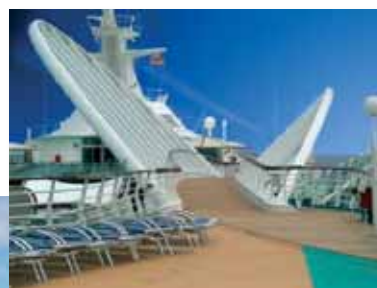
orkesterikorokkeen putkikäyrät Ø168,3 R-2000 → 5000 mm
