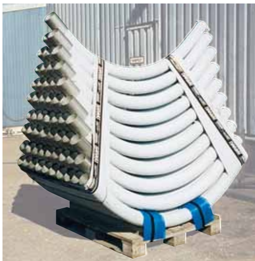
Suojaamme putket muovikalvolla taivutusta varten.
